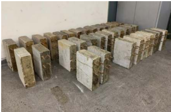
प्रबलित कंक्रीट के कैथोडिक संरक्षण पर अनुसंधान और विकास परियोजना के तहत प्रयोगशाला अध्ययन के लिए डाले गए नमूने
