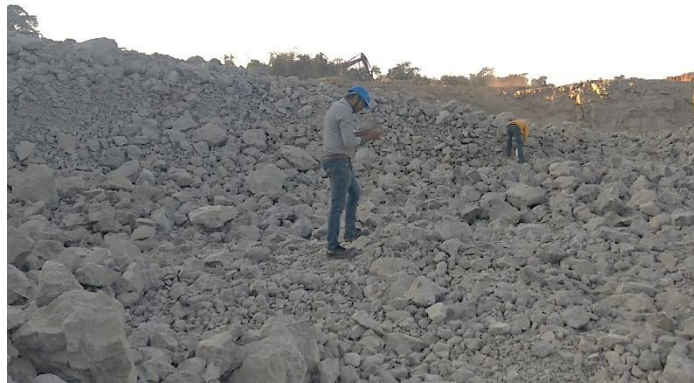
सीमेंट प्लांट के चूना पत्थर की खान में नमूना लेना
