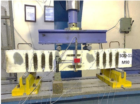
कतरनी में प्रबलित उच्च शक्ति कंक्रीट बीम का परीक्षण
