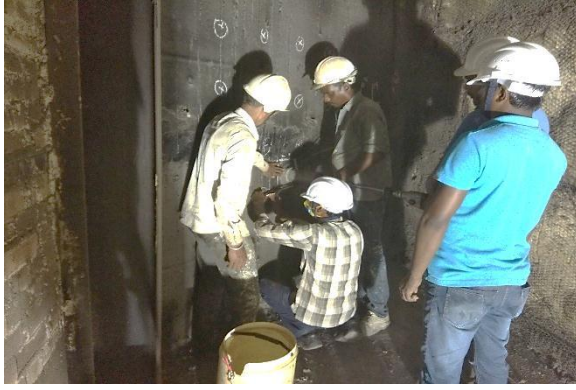
एनटीपीसी रामागुंडम के आरसीसी चिमनी के इनर शेल से कंक्रीट कोर का निष्कर्षण
