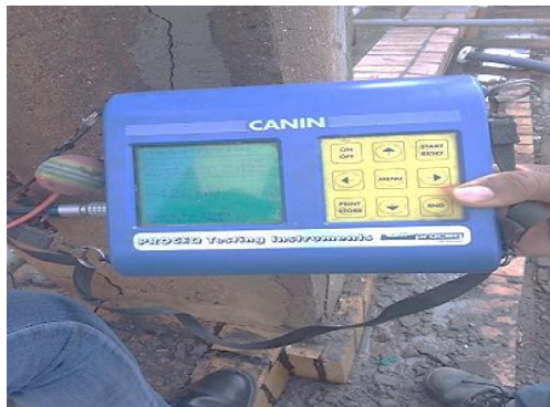
एनटीपीसी झंवर में थोक भंडारण टैंक पर आधा सेल मापन परीक्षण
