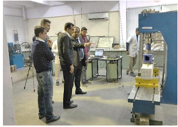
कतरनी में प्रबलित उच्च शक्ति कंक्रीट बीम का परीक्षण
