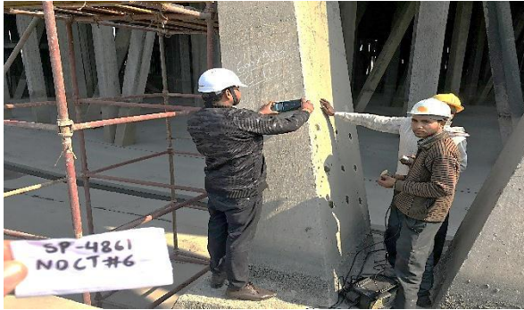
एनटीपीसी दादरी में नैचुरल ड्राफ्ट कूलिंग टॉवर में प्रोफार्मा परीक्षण
