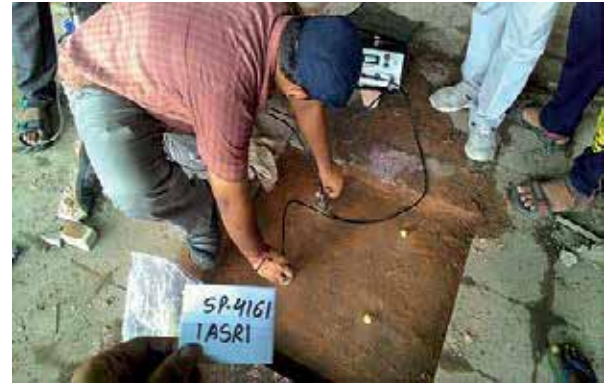
आईएसआरआई, पूसा, नई दिल्ली में नमूना सवैक्षण ब्लाक (बैक विंग) में आरसीसी स्लैब पर सतही जांच के माध्यम से की जा रही यूपीवी जांच
