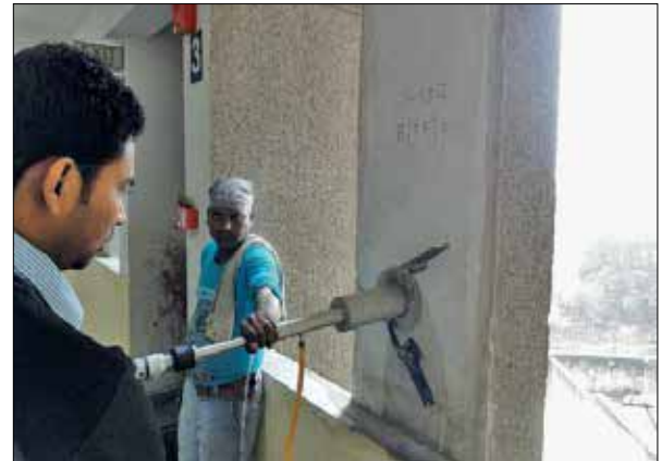
ओएफओसीजीएसएच, द्वारका, दिल्ली के आरसीसी कालम से कंक्रीट अभ्यंतर निकालते हुये
